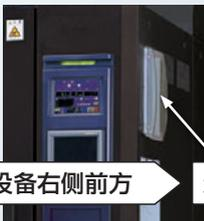
将电源接通用漏电断路器配置在设备前方右侧，可以从前方进行操作。
